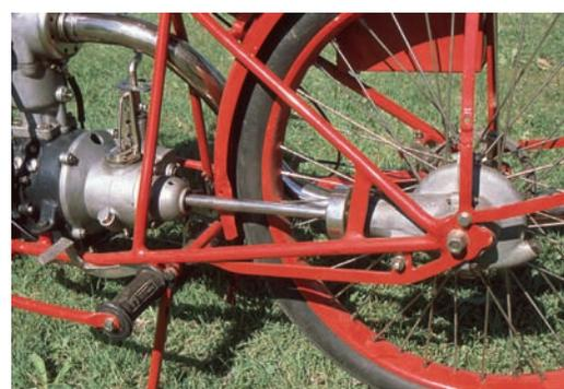
L'albero di trasmissione, sulla sinistra, con i due giunti cardanici. Si noti anche l'elemento di rinforzo del telaio.
