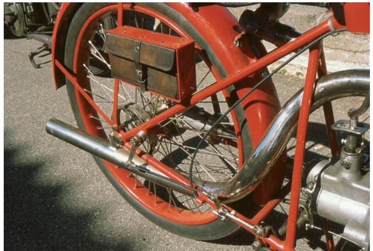
La ruota posteriore, con il freno a nastro avvolgente e parte dei cavi per l'interconnessione con quello anteriore. Il tubo di scarico è privo di silenziatore.
