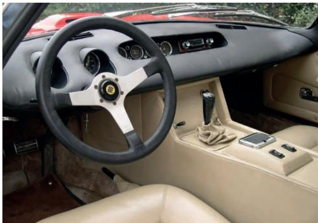
La massiccia plancia della vettura, nella quale sono separatamente "affogati" i due strumenti principali e i quattro ausiliari. Nel prototipo dello Spider, il cruscotto li conteneva tutti sotto un'unica palpebra.
