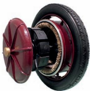
Il mozzo della ruota di una Lohner-Porsche mostra l'installazione coassiale del motore elettrico.
