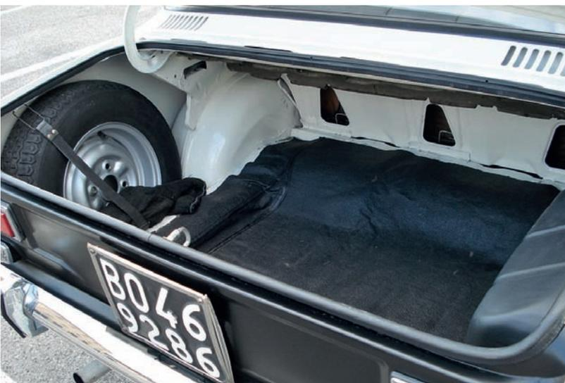
Bagagliaio con ruota di scorta e serbatoio ai lati del piano di carico (Escort).
