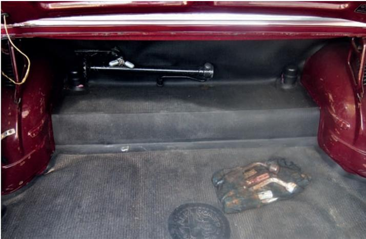
Bagagliaio ampio in larghezza (ruota di scorta e serbatoio sono sotto il piano di carico) e rivestito in gomma, con ferri in dotazione (Giulia).
