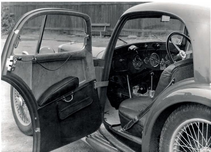
Per migliorare l'abitabilità, le porte della piccola MG di Klika sono incurvate verso l'esterno, sono scavate all'interno e hanno comodi braccioli. La ricca dotazione di strumenti del cruscotto fuori serie comprende anche un altimetro e un vacuometro.
