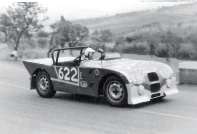
l'ingombro del propulsore che impediva forme più deportanti e rastremate per l'anteriore mentre per il posteriore, in particolare la coda, fu adottato un profilo più rialzato per aumentare il carico aerodinamico, la carrozzeria era formata da 6 elementi con i cofani completamente apribili per accedere più facilmente alla meccanica ed alla telaistica, che rimaneva pressoché identica
