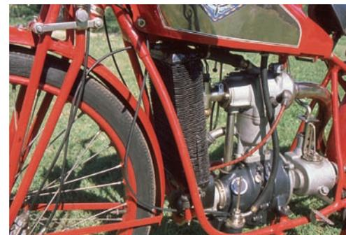
In basso sulla sinistra, dietro il magnete, è visibile il dispositivo che regola l'afflusso dell'olio all'albero motore.
