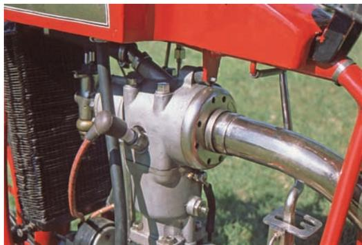
Il distributore rotante visto da sinistra, con l'unione a flangia del tubo di scarico al distributore stesso.
