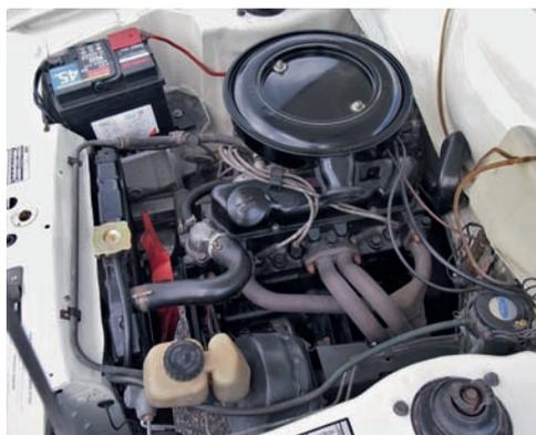
Il robusto 4 cilindri in linea della Escort, sovrastato in parte dalla scatola del filtro dell'aria che nasconde il carburatore doppio corpo Weber.
