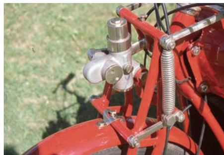
La forcella a parallelogramma con le molle laterali in trazione e la ruota con il freno a tamburo e la gomma a tallone.
