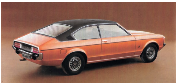
Una Granada coupé GL del 1976; sulla base della versione Ghia di questa slanciata versione dell'ammiraglia Ford, la carrozzeria inglese Coleman Milne allestì una piccola serie di intriganti limousine, denominate Grosvenor, contraddistinte dall'allungamento del passo e dall'adozione delle porte posteriori.
