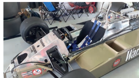
La Arrows A3 di Jochen Mass e Riccardo Patrese è un esempio bellissimo dei monoscocca in alluminio rivettato come usavano negli anni settanta prima dell'arrivo delle fibre di carbonio.
