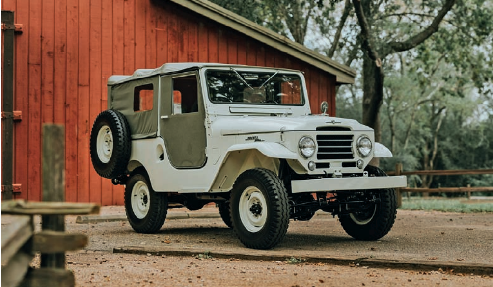
Il Toyota Land Cruiser del 1955 salverà l'azienda dalla disfatta con la Crown negli USA, con motore 6 cilindri da 3.9 litri e 133 CV.
