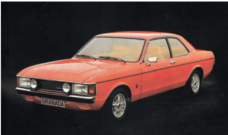
Le Granada equipaggiate con il pacchetto sportivo S, disponibile con qualsiasi allestimento ma solo con i motori più aitari, si contraddistinguono per un assetto ribassato di 12 mm al retrotreno, ammortizzatori specifici Bilstein, molle elicoidali più rigide, cerchi in lega con gommatura da 195.
