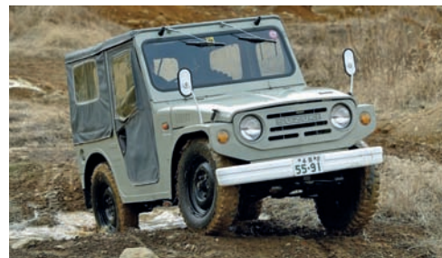
Spinta inizialmente da un bicilindrico da 357 cc e 25 CV, la Suzuki Jimny (LJ10) del 1970 è economica solida e sfruttabile.
