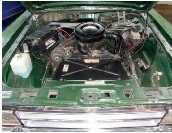
Un'immagine di 2 fra i vari motori disponibili nella gamma della Granada Made In Cologne: il V6 da 2,6 litri (visibile nel vano motore della vettura azzurra) e il piccolo V4 da 1,7 litri, piazzato sotto al cofano della vettura verde e decisamente più compatto, specie in lunghezza, del fratello maggiore.
