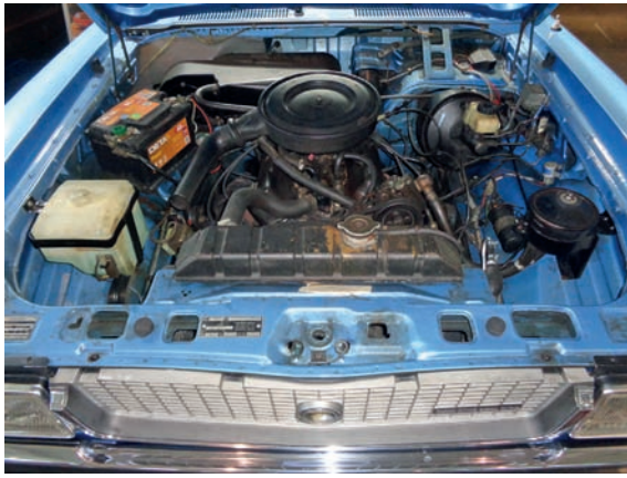
Un'immagine di 2 fra i vari motori disponibili nella gamma della Granada Made In Cologne: il V6 da 2,6 litri (visibile nel vano motore della vettura azzurra) e il piccolo V4 da 1,7 litri, piazzato sotto al cofano della vettura verde e decisamente più compatto, specie in lunghezza, del fratello maggiore.
