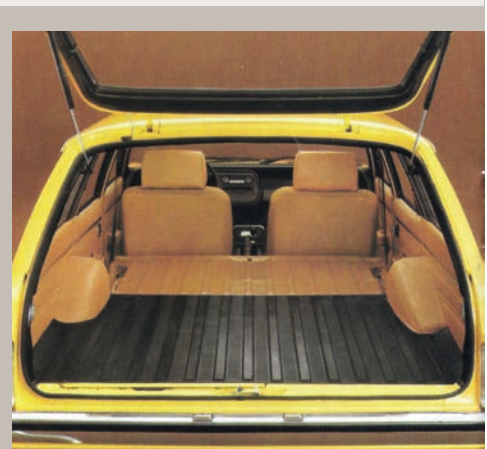
Anche la station wagon, altrimenti nota come Turnier in Germania e Estate in Gran Bretagna, dopo il restyling del '75 abbandona il cromo in cambio del nero opaco. A differenza delle berline, le successive Granada MKII wagon manterranno pressoché inalterata la parte posteriore del corpo vettura. Il vano di carico è semplicemente enorme: a sedili posteriori in posizione il volume a disposizione equivale a 1180 dmc, a sedili abbassati arriva addirittura a 2180 dmc... Altrettanto immensa, in quest'ultima configurazione, la superficie del piano di carico, che arriva a misurare 203,9 cm x 161!
