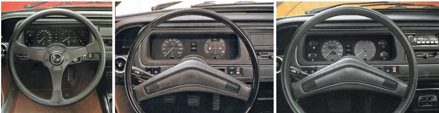
Carrellata di posti guida delle Granada '75-'77: il pacchetto S (a sinistra) offre un volante a tre razze di intonazione sportiva e una strumentazione pressoché completa; quest'ultima è peraltro una prerogativa delle Granada offerte in allestimento GL (a destra), mentre le versioni base offrono solo l'essenziale (al centro).
