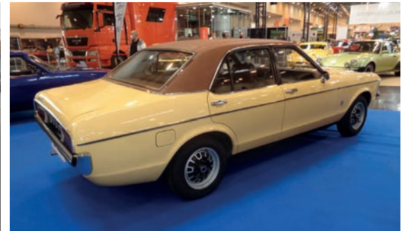
Il tocco più americaneggiante delle Consul e Granada è forse la coda, in particolare i vistosi gruppi ottici; il baule delle berline è capace di 450 dmc, di cui almeno 389 utilizzabili per le valigie. Notare le piccole prese d'aria sul montante destinate alla ventilazione dell'abitacolo.
