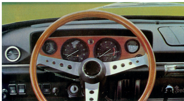
Il posto di guida del coupé S è simile a quello della berlina. A dare il tocco sportivo è il volante a razze forate con corona in legno e il cruscotto, con strumenti circolari su fondo rivestito di legno.
