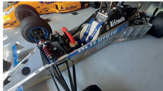
Le chiamavano "a freccia" e si capisce perché guardando il telaio nudo della Osella FA1E (telaio n.3) del 1983. Il 1983 è il primo anno con vetture dal fondo piatto e la prima reazione dei progettisti fu quella di ... eliminare il fondo temendo che sotto la vettura si potesse generare una pressione elevata dannosa per la tenuta di strada. Inoltre, con lo spostamento di tutti gli accessori verso la parte posteriore, si cercava di recuperare trazione caricando le ruote motrici con il peso statico, visto che quello dovuto all'effetto suolo non c'era più. Interessante notare anche l'accoppiamento della vasca in alluminio e del "coperchio" superiore in fibra di carbonio. I materiali compositi generavano ancora diffidenza e si pensava che una base in alluminio desse maggiori garanzie di assorbimento in caso di urto. Tutto l'insieme appare di una semplicità disarmante e viene da pensare che protezione per il pilota una struttura del genere potesse offrire, ma era lo standard dell'epoca. Anche la ben più blasonata Brabham BT52 era fatta così.
