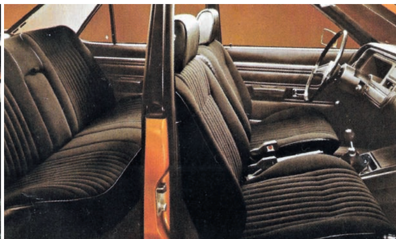
Qualche dato dimensionale dell'abitacolo delle Granada: in larghezza ci sono 150 cm alle spalle sia davanti che dietro, le sedute dei sedili offrono 48 cm, l'altezza dal fondo delle sedute è di 90 cm davanti, 86 dietro, e ci sono fra i 40 e i 54 cm di spazio per le gambe dei passeggeri anteriori, fra i 37 e i 23 per chi siede dietro.
