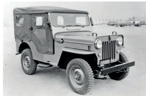
La Mitsubishi Jeep Willys JP-spec (J3, 1953-1973) conserva non solo la tecnica e l'aspetto, ma anche il motore quattro cilindri 2.2 litri Hurricane della CJ.
