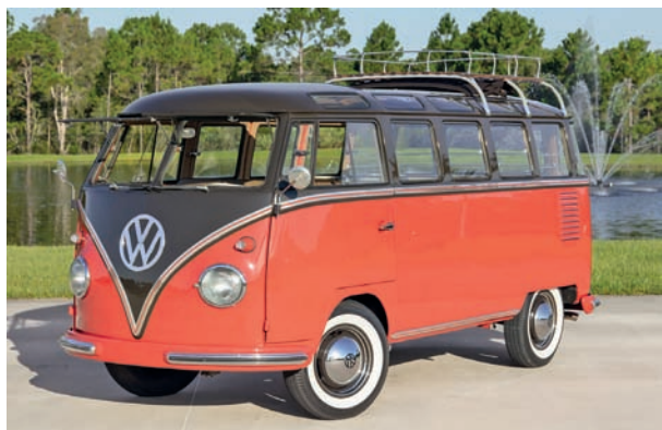
In alto e a sinistra un esemplare del 1956; si noti la coda modificata nel 1955, col cofano motore basso, il portellone del bagagliaio che in precedenza era assente e il vero paraurti nello stile di quello anteriore. Dal 1955 le alette di ventilazione del motore sono 9. Gli pneumatici a fianco bianco e il portapacchi sul tetto erano optional; dal 1956 i lampeggiatori anteriori "codice" erano già obbligatori per il mercato USA. A destra, la plancia e il volante ridisegnati introdotti nel 1955 e rimasti invariati fino al termine della produzione.
