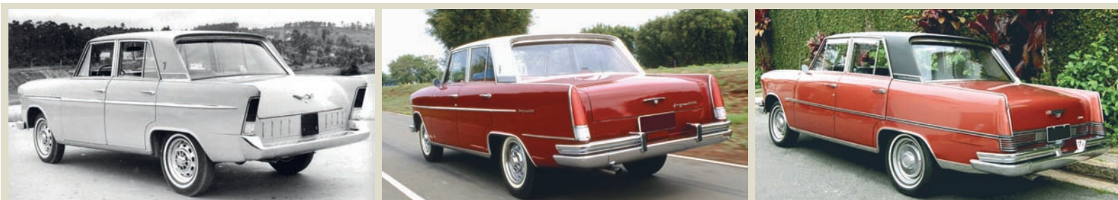
Un confronto fra le viste posteriori. A sinistra la Aero 2600: è ben visibile il cofano del baule del 1952, dissimulato fra le vistose pinne. Con il restyling del 1965, foto al centro, la vettura ricevette una coda moderna e squadrata. A destra la Itamaraty che si distingueva dalla Aero 2600 per i nuovi fanali posteriori ad andamento orizzontale.
