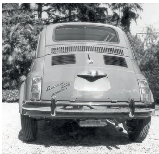
La Fiat-Giannini 500 TV Special con il motore da 29 CV SAE e il prezzo di 598.000 Lire si pone a metà strada fra il modello 500 TV che ha 27 CV e la 500 Montecarlo che, dopo l'elaborazione per le corse, ha la potenza che varia fra i 38 CV e i 43 CV.
