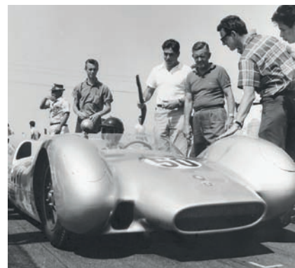
Ken Miles a Pomona il 14 luglio 1963 con la Dolphin America "Special" Sport biposto progettata da Bud Hull e John Crosthwaite su richiesta di Otto Zipper: telaio a reticolo spaziale di tubi, motore Porsche di 1600 cc o di 1700 cc e freni a disco della Triumph TR4 con pinze Girling.
