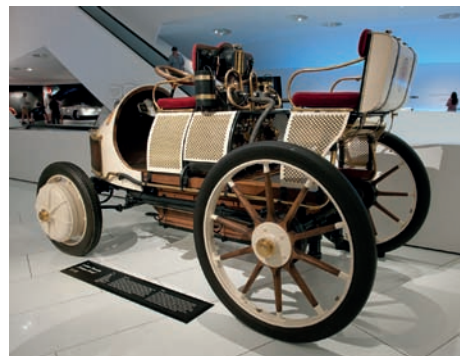
Trattore Porsche Super L318 del 1949. Questo esemplare didattico ricorda i trattori agricoli diesel che permisero la sopravvivenza e lo sviluppo iniziale della marca. Al centro Lohner Mixte del 1901, replica di uno dei primi progetti di Ferdinand Porsche (1875-1951) agli inizi della carriera. Motorizzazione ibrida con i motori elettrici direttamente sulle ruote anteriori. A destra, replica moderna della carrozzeria in alluminio della Typ 64, progettata dallo Studio Porsche per la Volkswagen aerodinamica destinata alla corsa Berlino-Roma-Berlino del 1939. Sotto una delle prime Porsche 356, la Coupé telaio # 5056 donata a Ferdinand Porsche il 3 settembre 1950 per il 75° compleanno e poi utilizzata per le prove con targa Versuchs Wagen 141.
