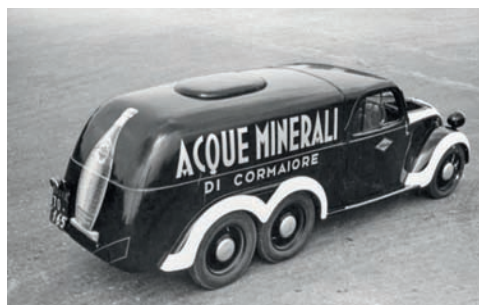
Una delle Fiat 500 A "Topolino" modificata dagli Ollearo per aumentare la capacità di carico.
