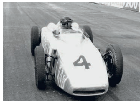
Maria Teresa de Filippis prova la Behra-Porsche con la quale tenterà invano di qualificarsi a Montecarlo. La vettura era stata realizzata sulla base dello spider Porsche in collaborazione con Valerio Colotti.
