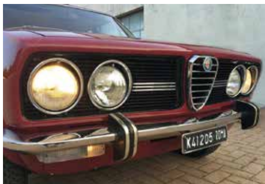
ALFA ROMEO SEMPRE ALL'AVANGUARDIA L'Alfa Romeo è fra le prime Case italiane a montare fari principali alogeni di serie. Nella foto l'Alfetta prima serie del 1972 dotata di anabbaglianti e abbaglianti con lampade H1 a un filamento, che si accendono alternativamente.
