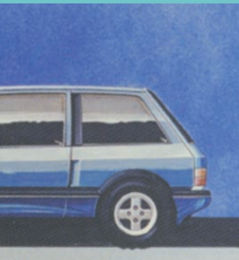
Si nota il particolare della maniglia a scomparsa in cavo sulla fiancata.
