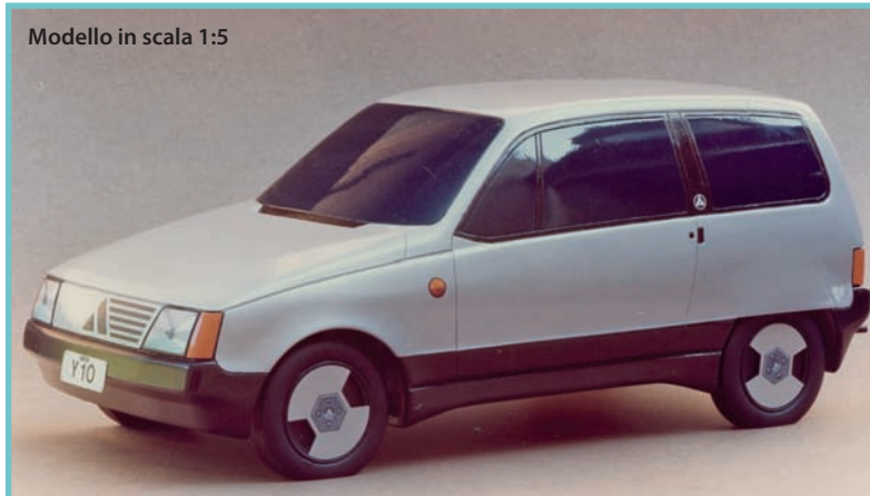
Nel 1980 arrivò l'ordine al Centro Stile interno di impostare la nuova Autobianchi partendo dal pianale della Panda. Questa è la prima proposta, definita in un modello verosimilmente in scala 1:5, realizzato da Antonio Piovano nello stesso anno.
