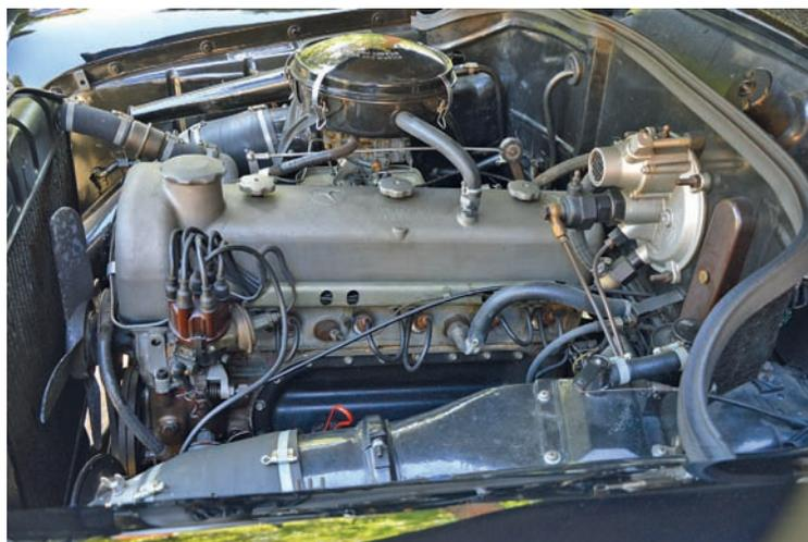
Due viste del vano motore in ottime condizioni; da notare il voluminoso servo freno disponibile solo negli ultimi esemplari della 220 A.
