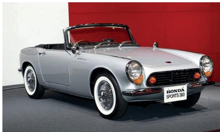
Il prototipo Honda S360 presentato nel giugno 1962 sviluppa in senso sportivo il concetto delle "Keijidōsha". Il motore con 4 cilindri e due alberi a camme in testa sviluppa 33 CV. Per la produzione la casa preferirà la versione di 500 cc.
