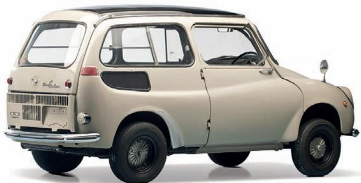
La versione giardiniera della Subaru 360 si chiama Custom, ha la stessa meccanica della berlina con il motore che sviluppa 18 CV ma pesa 450 kg invece di 400 kg e ha il rapporto finale più corto, perciò è più lenta: 85 km/h invece di 95 km/h.
