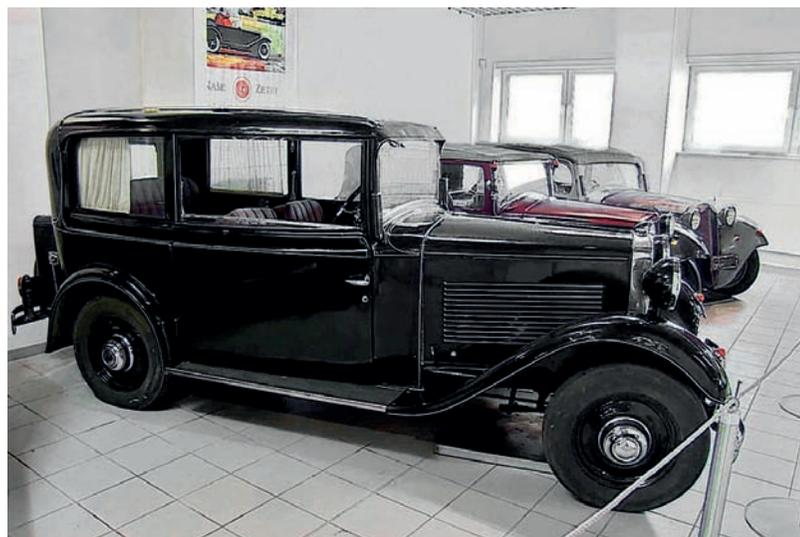
Tecnicamente ortodossa (motore due cilindri a due tempi di 993 cm<sup>3</sup> con 22 CV), la Z9 patì un prezzo elevato che ne limitò la produzione - 850 esemplari - al solo biennio 1930-32.
