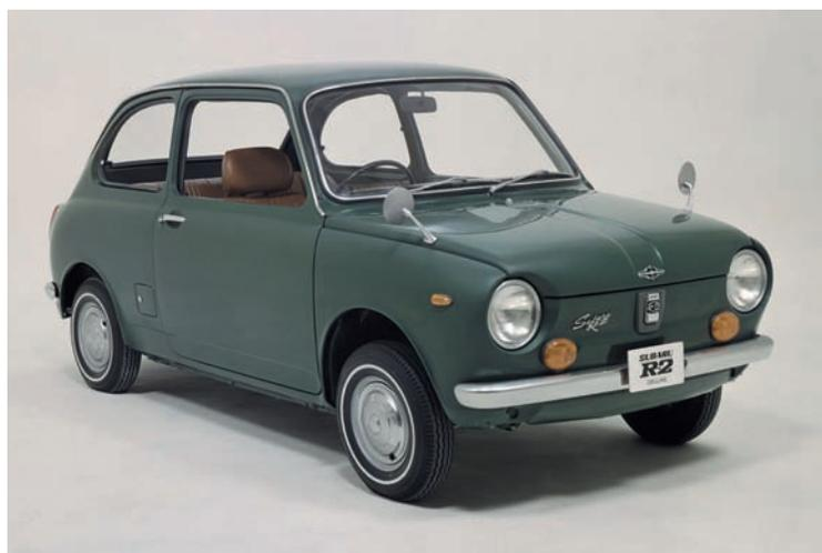
Nel 1969 la Subaru R-2 succede alla 360 con la meccanica e l'aspetto più moderni. Il motore bicilindrico a due tempi è ora raffreddato ad acqua: nella versione normale ha la potenza massima di 31 CV, nella SS di 36 CV.
