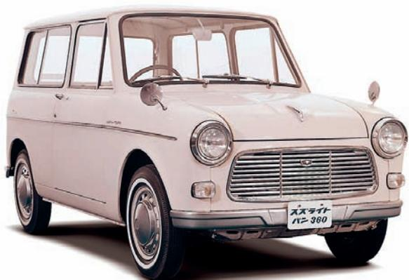
Nel 1962 la Suzulight (nella foto la station wagon) evolve mantenendo lo schema meccanico "tuttoavanti" in un involucro estetico-funzionale più moderno. Nel 1963 il motore è potenziato a 21 CV ed è dotato della lubrificazione automatica.
