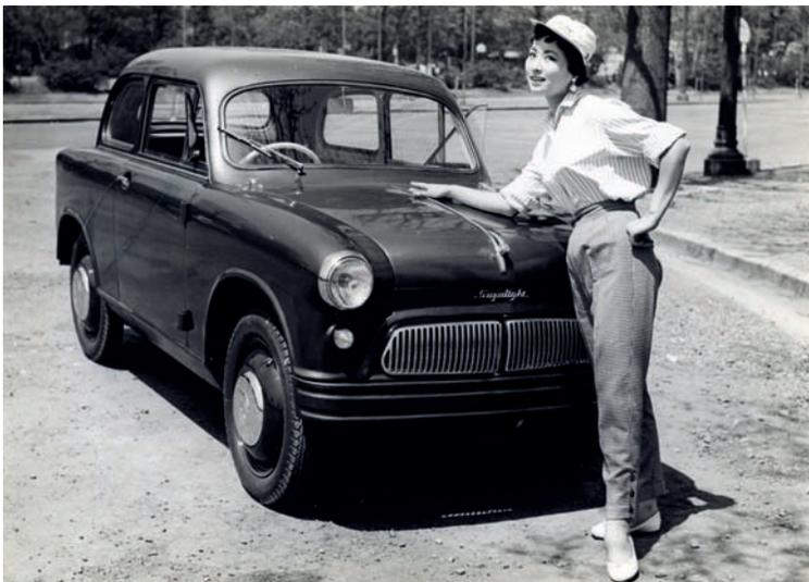
La Suzukilight SS arriva nel 1955 conforme al regolamento "keijidōsha" prima delle altre perché il telaio, il motore bicilindrico a due tempi di 360 cc e la trazione anteriore sono copiati dalla tedesca Lloyd 400 LP.
