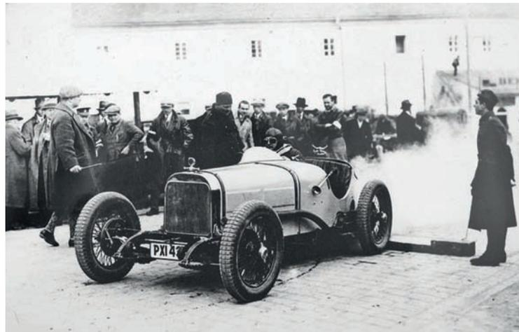
La Z6V è stata una delle rare vetture sportive a montare un motore realizzato secondo il "sistema Junkers". L'originalità tecnica (2 tempi, 6 cilindri e 12 pistoni controrotanti) diede la desiderata visibilità alla Casa, relegando in secondo piano i pochi successi in gara.
