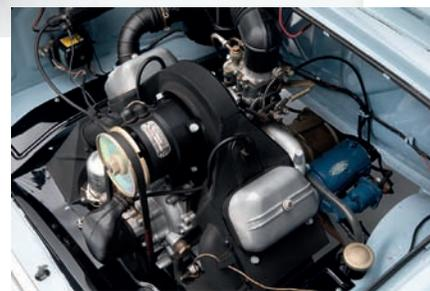
Il motore posteriore a quattro tempi con distribuzione ad aste e bilancieri della Mazda R360 Coupe ha due cilindri a V, è raffreddato ad aria forzata e ha la potenza di 16 CV. Il cambio può essere a 4 marce o semiautomatico con convertitore di coppia.
