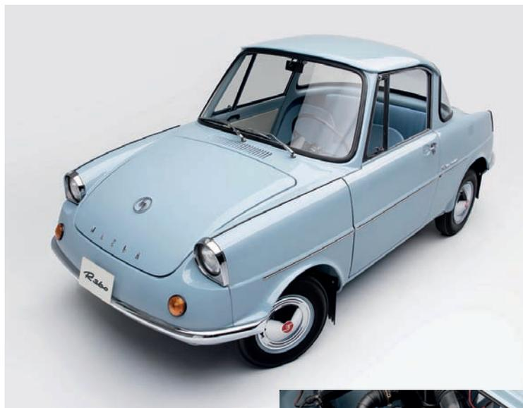
La Mazda R360 Coupe presentata nel 1960 ha la carrozzeria portante e il motore posteriore. Pesa 395 kg e fila a 90 km/h. A dispetto delle apparenze, ha quattro posti ma i posteriori non si possono definire del tutto comodi per i nostri standard.
