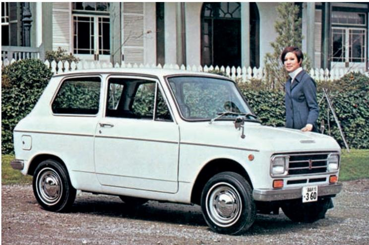
La Daihatsu Fellow del 1966 ha il motore anteriore bicilindrico a due tempi raffreddato ad acqua che pesa 58 kg e sviluppa 23 CV, la trazione posteriore e il cambio a quattro marce. Le linee squadrate favoriscono la spaziosità dell'abitacolo.
