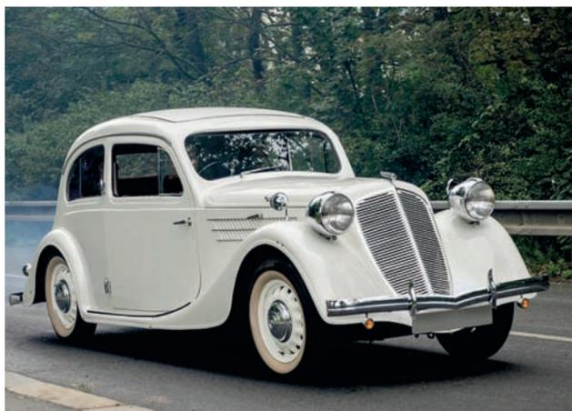
*Quello della Z5 è un raro caso di motore a due tempi con quattro cilindri, raffreddato ad acqua. Si tratta di un 1470 cm<sup>3</sup> (72mm x 90mm) con 40 CV che permetteva una velocità massima di 125 km/ora.*
