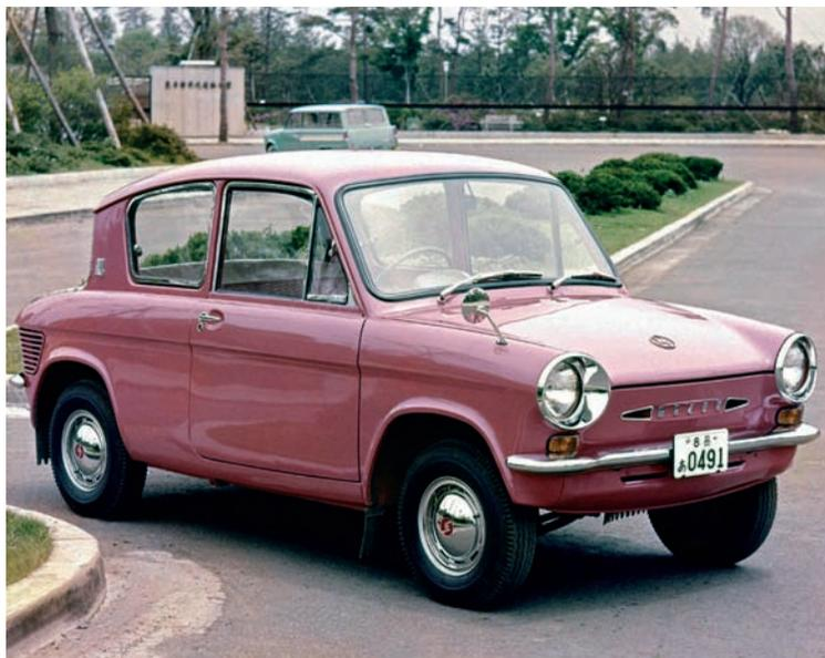
La Mazda Carol del 1962 ha le dimensioni esterne della R360 Coupe, ma ha il passo più lungo per una migliore abitabilità. Il motore a 4 tempi ha 4 cilindri, è raffreddato ad acqua ed è montato trasversalmente. All'inizio ha 18 CV, poi 20 CV.
