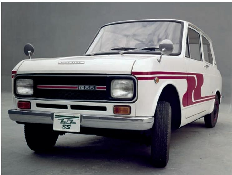
La Daihatsu Fellow SS presentata nel 1967 ha il motore bicilindrico a due tempi raffreddato ad acqua che sviluppa 32 CV. È la prima "Keijidōsha" il cui motore supera in potenza quello della Honda N360.
