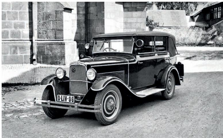
Una Z9 carrozzata da Sodomka in una versione torpedo che si distingue per il fregio sotto la linea di cintura, necessario per alleggerirla, tipico della scuola tedesca.
