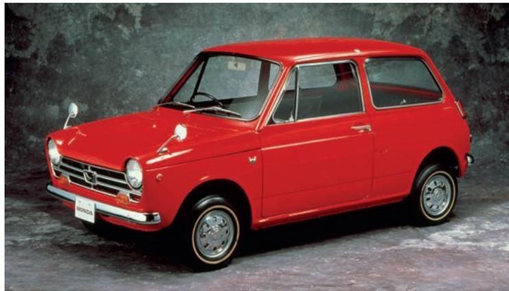
La Honda N360 arriva nel 1967 dopo 10 anni spesi per perfezionare al massimo ogni aspetto tecnico e costruttivo. Il motore raffreddato ad aria con 2 cilindri e l'albero a camme in testa sviluppa 31 CV e scatena la corsa alla potenza.
