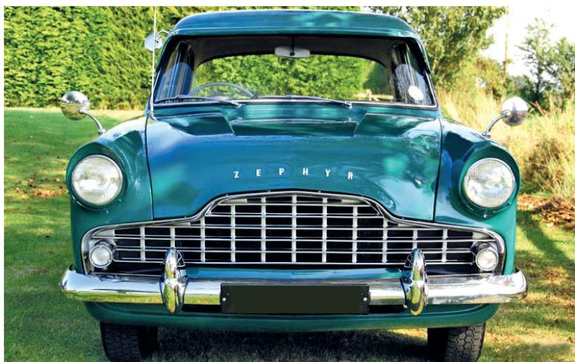
Fino all'ottobre 1957, la Zephyr adottò una calandra sportiveggiante a maglie quadre (eggcrate), che si addiceva poco a una tranquilla berlina, seppur dotata di motore a 6 cilindri. Le luci di posizione e direzione, incorporate, erano tonde.
