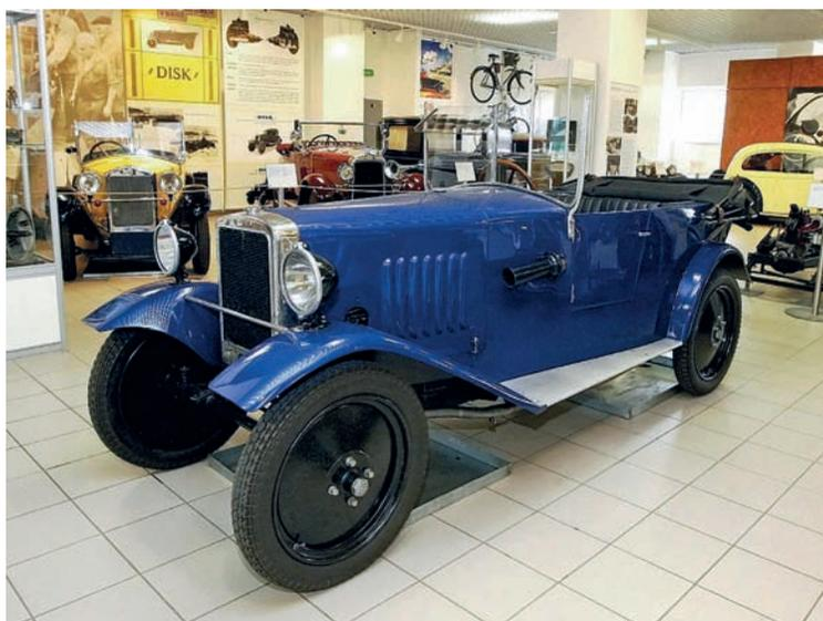
Z "Disk". Il suo nome è dovuto al particolare sistema di invio del moto dall'albero motore a quello di trasmissione. Pur nell'insuccesso, rimane il primo esempio europeo di vettura con motore a due tempi.
