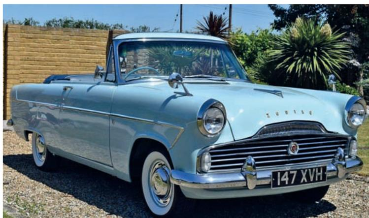
La cabriolet vantava due configurazioni della capote: "de ville" (aperta solo nella parte anteriore, arrotolandola manualmente) e tutta aperta (con mantice posteriore). Sulla Zodiac (nella foto) e sulla Zephyr l'azionamento del mantice era elettroidraulico.
