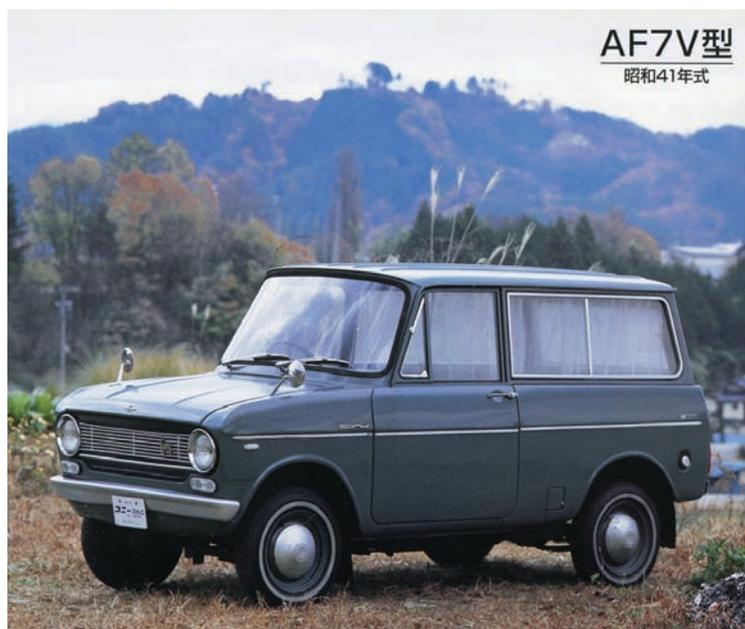
La Cony 360 AF7V del 1962 deriva dai furgoni leggeri che sono la specialità della Casa. Il motore bicilindrico boxer a 4 tempi raffreddato ad aria sviluppa 15 CV, appena sufficienti per spingere a 78 km/h la vetturetta che pesa 575 kg.
