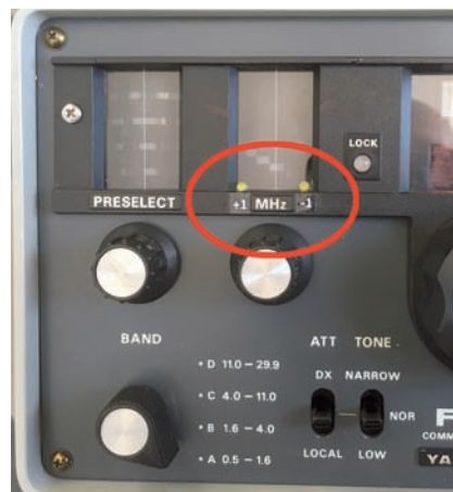
Figura 12 - I due LED gialli "MHz over-range +1 e -1" posti nella parte inferiore della finestra "MHz" dell'FRG-7.
