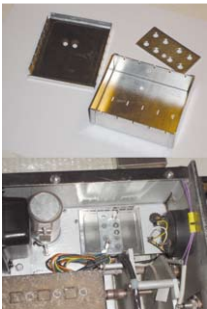
Fig. 2 - Nella foto superiore compare l'hardware utilizzato per il fissaggio del nuovo BFO subchassis, che nella foto inferiore si vede già fissato al telaio del G-187.
