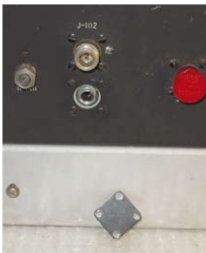
Fig. 4 - Il Jack di uscita per l'altoparlante è montato in un foro inutilizzato del pannello posteriore.
