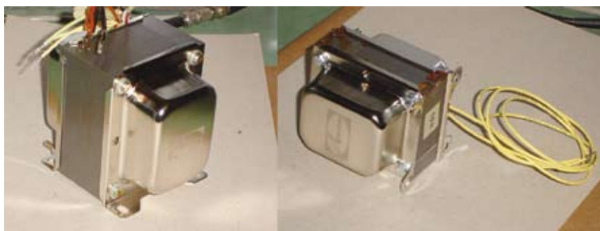
Fig. 5 - Il nuovo trasformatore costruito su specifiche e la nuova impedenza di filtro da 10 H - 250 mA.
