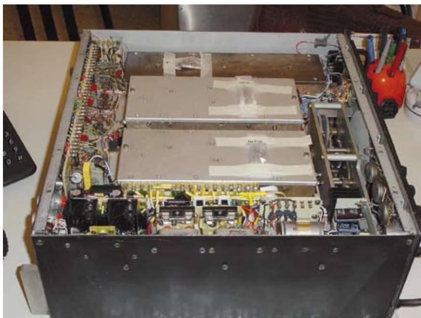
Fig. 1 - Le nuove basette dei filtri a cristallo saranno fissate al coperchio inferiore del subchassis relativo ai due canali IF a 21,4 MHz (sul lato sinistro dell'apparecchio ed in alto nella foto). Esse potranno anche essere racchiuse in opportuni contenitori metallici.
